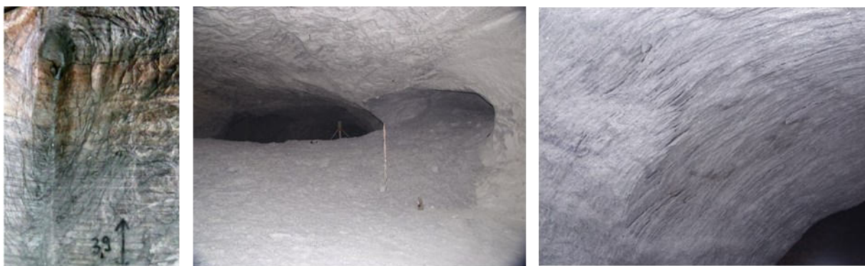
Abbildung 3: Gas- und Gas-Salz-Ausbrüche in Kaliflözen
