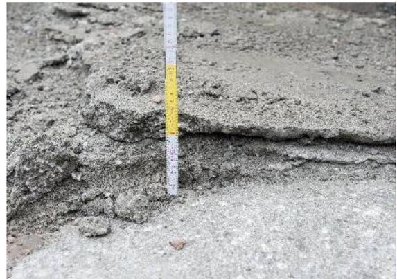
Abbildung 93: Schollenartige Ablösungen nach der Impulsverdichtung im Gesenkversuch 2017
