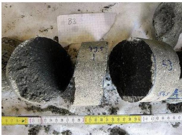
Abbildung 55: Die Bohrkernproben wurden entlang der Grafit-schichten lagenweise gespalten (STG-3)
