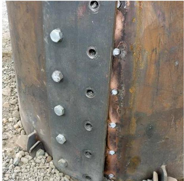
Abbildung 24: Havarie des Stahlbehälters durch Versagen der Verschraubung (M20 8.8)
