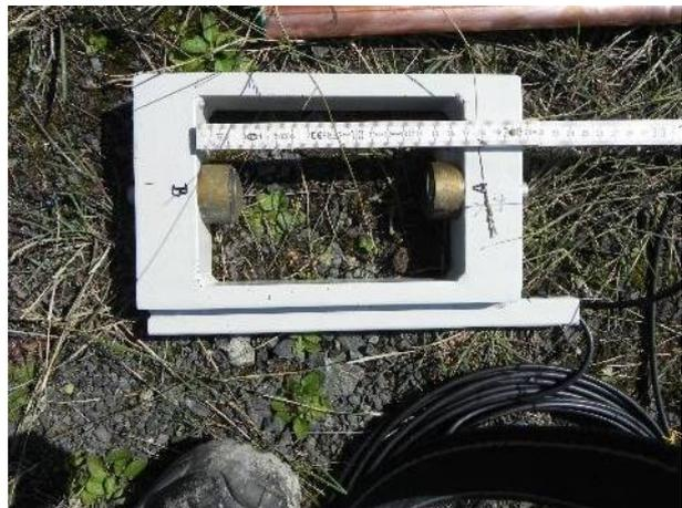
Abbildung 76: Ultraschallsonde des IfG Leipzig
