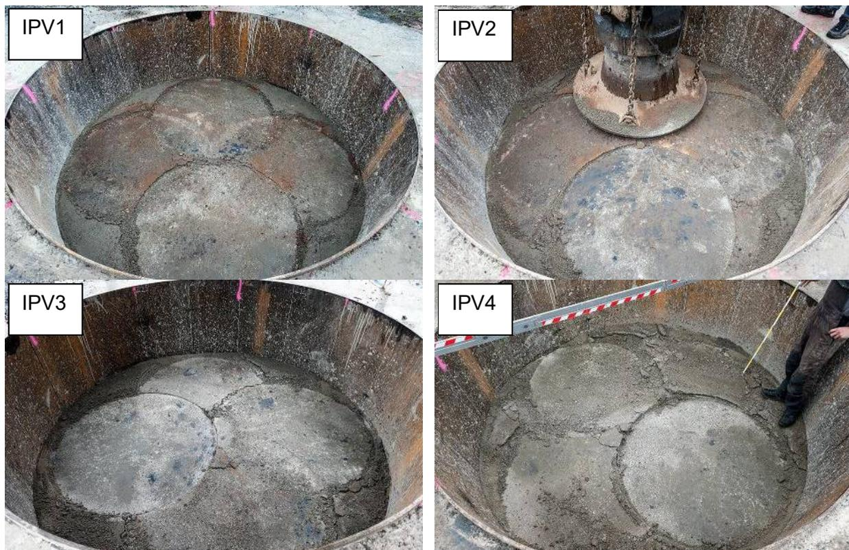
Abbildung 47: Typische Auflockerungen der Schichtoberfläche infolge des Eindrückens des Verdichterfußes
