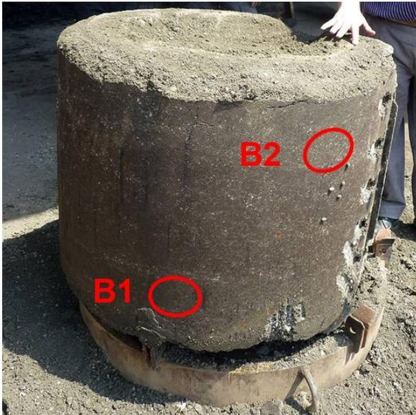
Abbildung 25: Im Vorversuch gewonnene Probe mit den Ansatzpunkten der Kernbohrungen
