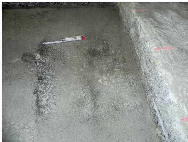
Abbildung 19: Oberflächenschäden infolge Überverdichtung durch RP3 (M1L4)
