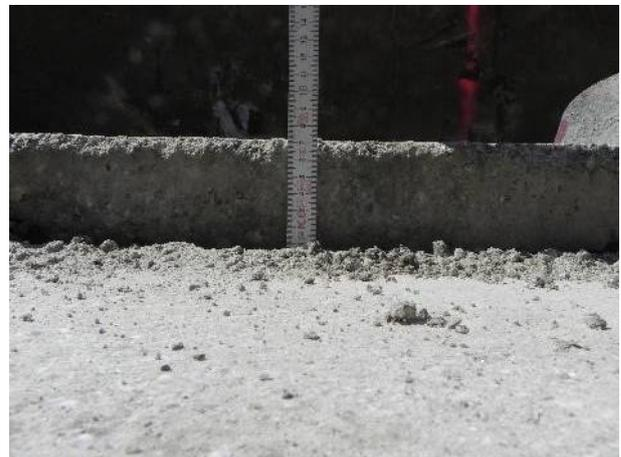
Abbildung 96: Stanzeffekt der Impulsverdichtung im Gesenkversuch 2017
