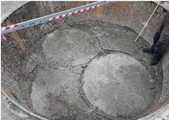
Abbildung 92: Zustand der Oberfläche nach der Impulsverdichtung im Gesenkversuch 2015
