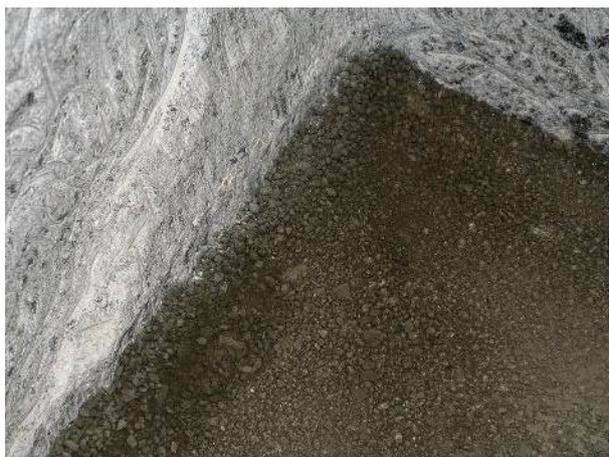
Abbildung 18: Materialaufschiebungen im Randbereich bei der Rezeptur OBSM (M1L1)
