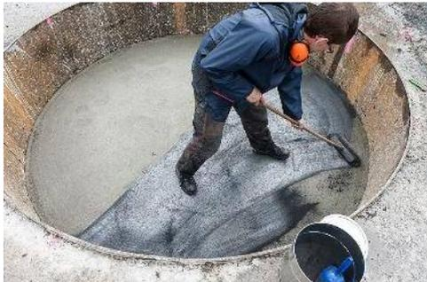
Um bei der späteren Beprobung die einzelnen Einbaulagen identifizieren zu können, wurde nach der Vorverdichtung ein Teil der Oberfläche mit einem feinen Graphitpuder behandelt. Dabei wurden jeweils ca. 100 g des Graphitpuders mit einem Besen in die verdichtete Oberfläche der Einbaulage „eingerieben“ (Abbildung 43).
