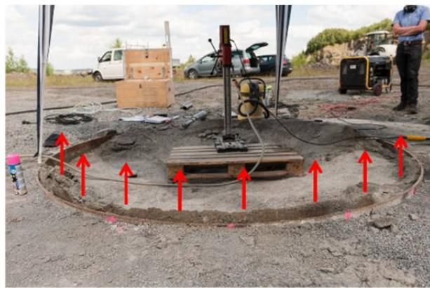
Abbildung 52: Über die gesamte Gesenkfläche hochgepresstes Schichtpaket
