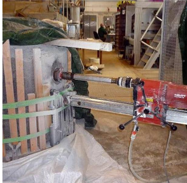
Abbildung 26: Luftgespülte Kernbohrung in der gewonnenen Probe (Bohrung 2)
