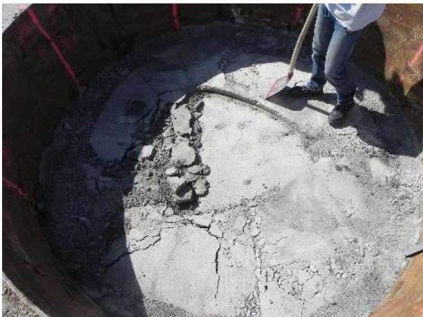
Abbildung 95: Zustand der Oberfläche nach der Impulsverdichtung im Gesenkversuch 2017
