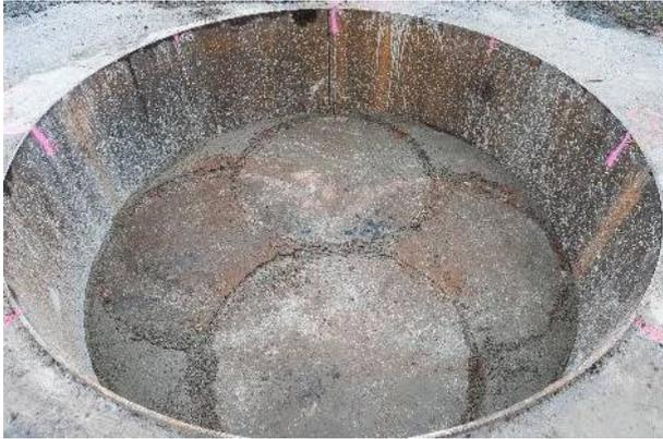
Abbildung 90: Bauzustand der ersten Schicht nach dem ersten Impulsverdichtungsdurchgang im Gesenkversuch 2015
