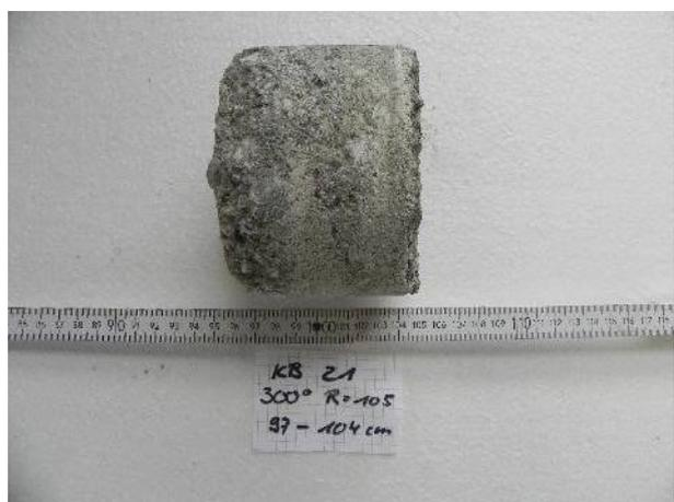
Abbildung 83: Kernstück aus dem Gesenkversuch
