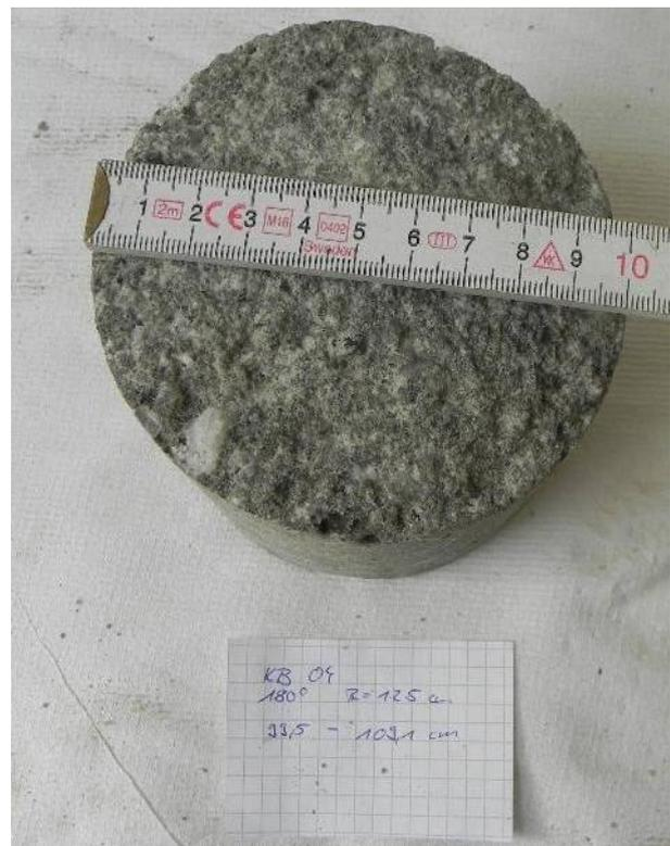
Abbildung 100: Rauhe Bruchfläche an einer Kernprobe
