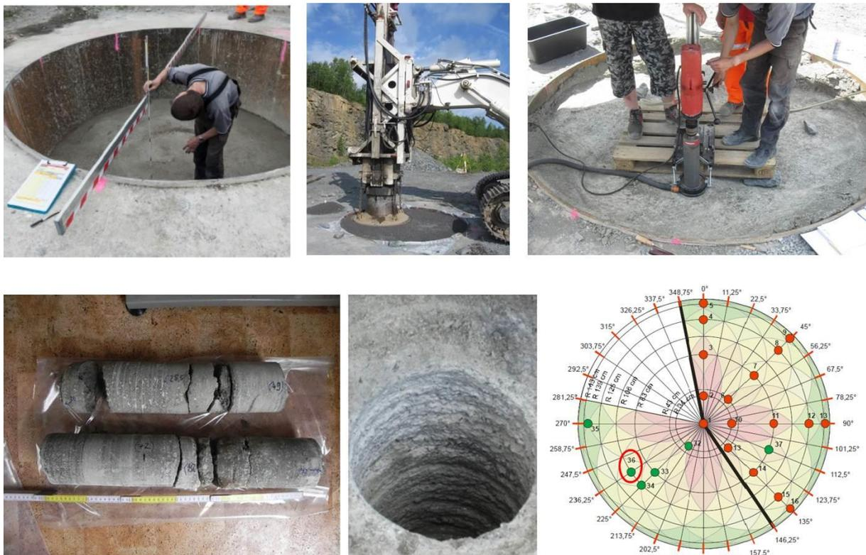
Abb. 5.1: Verdichtung des Testmaterials in einem kreisrunden Gesenk im Steinbruch Marxgrün sowie Proben-gewinnung für mikrostrukturelle Untersuchungen (Fotos: Uwe Glaubach, TUBAF)
