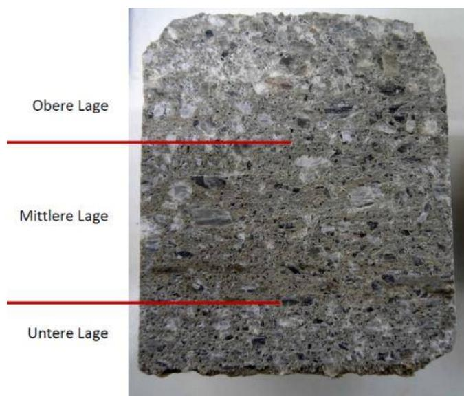
Abbildung 87: Kernprobe für die Dünnschliffanalyse
