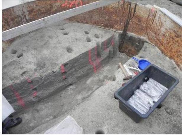
Abbildung 81: Versuchskörper nach der Beprobung
