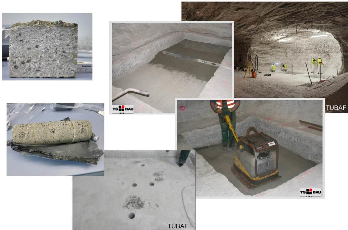
Abb. 4.1: In-situ Verdichtungsversuche im Bergwerk Sondershausen und Probengewinnung.
