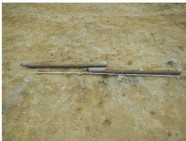
Abbildung 7: Bohrgestänge mit Kern
