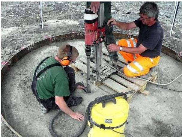
Abbildung 51: Probengewinnung mittels druckluftgespülter Kernbohrungen
