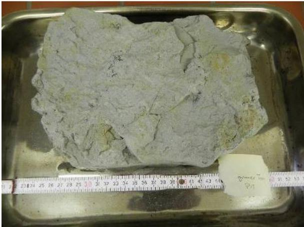
Abbildung 8: grauer Ton am Standort ASP-4
