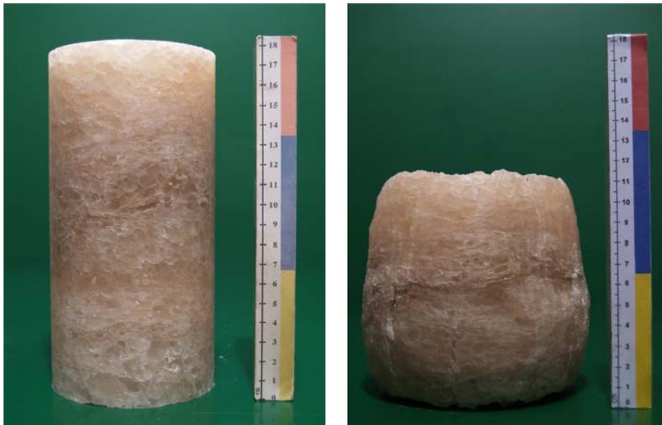
*Bild 4.39 Prüfkörper vor und nach der Versuchsdurchführung (Versuch Nr. 8)*
