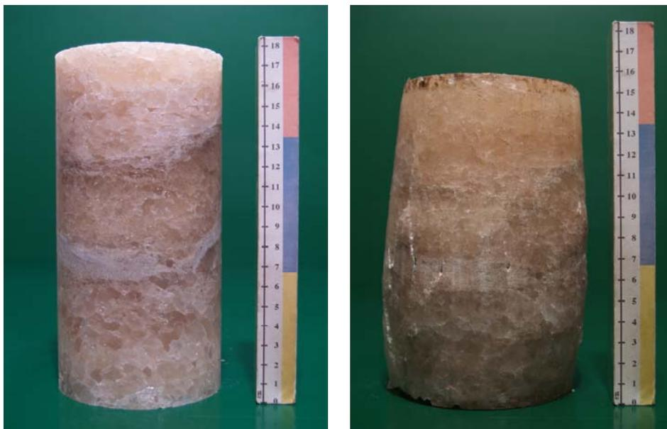
Bild 4.4 Prüfkörper vor und nach der Versuchsdurchführung (Versuch Nr. 1)
