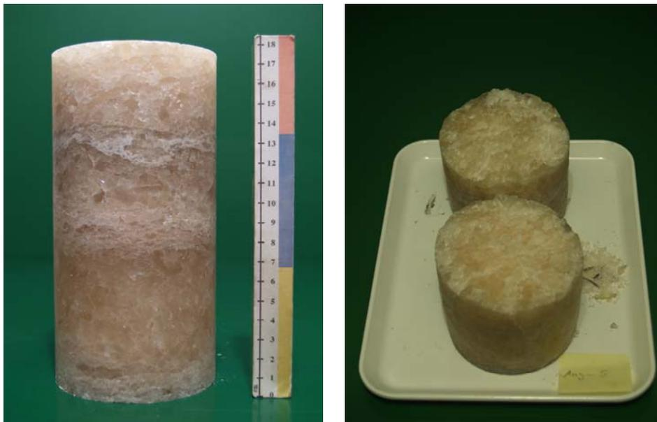
Bild 4.24 Prüfkörper vor und nach der Versuchsdurchführung (Versuch Nr. 5)
