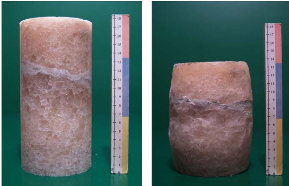
Bild 4.14 Prüfkörper vor und nach der Versuchsdurchführung (Versuch Nr. 3)
