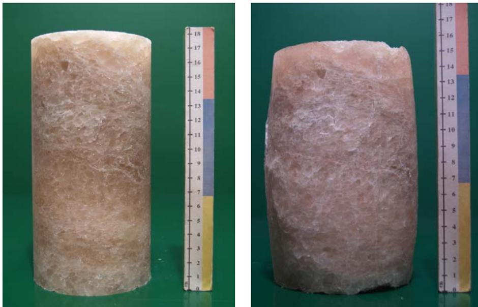
Bild 4.34 Prüfkörper vor und nach der Versuchsdurchführung (Versuch Nr. 7)
