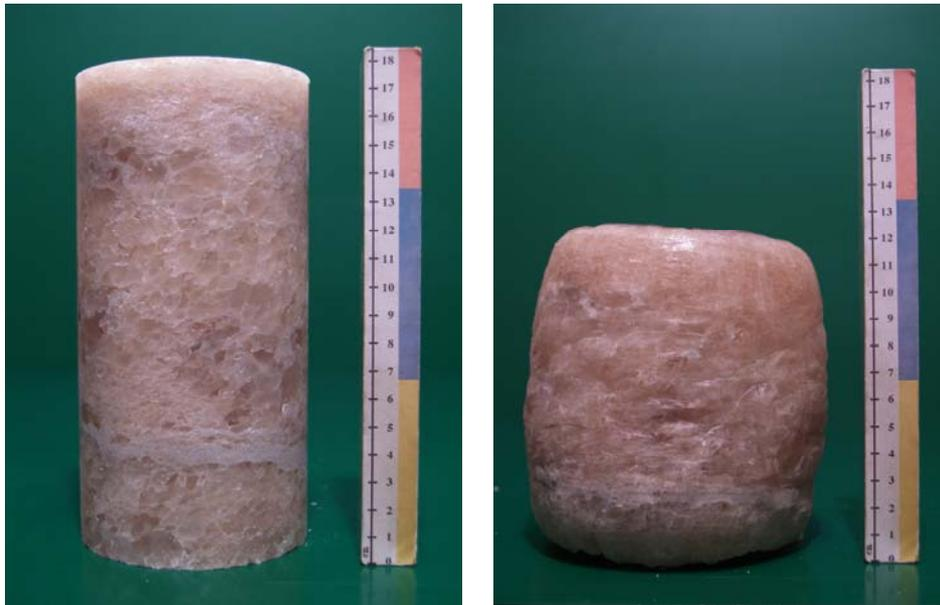
Bild 4.19 Prüfkörper vor und nach der Versuchsdurchführung (Versuch Nr. 4)
