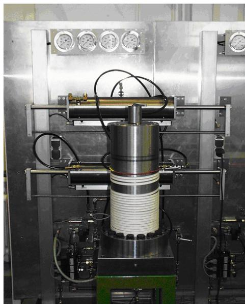
Bild 4.1 Triaxialprüfanlagen des Lehrstuhls für Deponietechnik und Geomechanik
