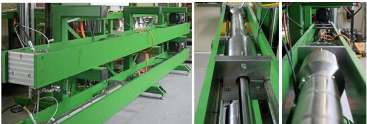
*Bild 4.4: Gesamtansicht zweier in einem Auflagerrahmen installierter EMC-Systeme (links), Steuerungsmotor des EMC-Systems (rechts im Hintergrund) und die durch den Elektromotor verfahrbare Zylinderstange des EMC-Systems (mittig im Vordergrund), mit der in dem mittig im Hintergrund sowie auch rechts im Vordergrund dargestellten Ölzylinder durch Ölverdrängung die Regulierung des Manteldrucks in der Prüfanlage erfolgt*
