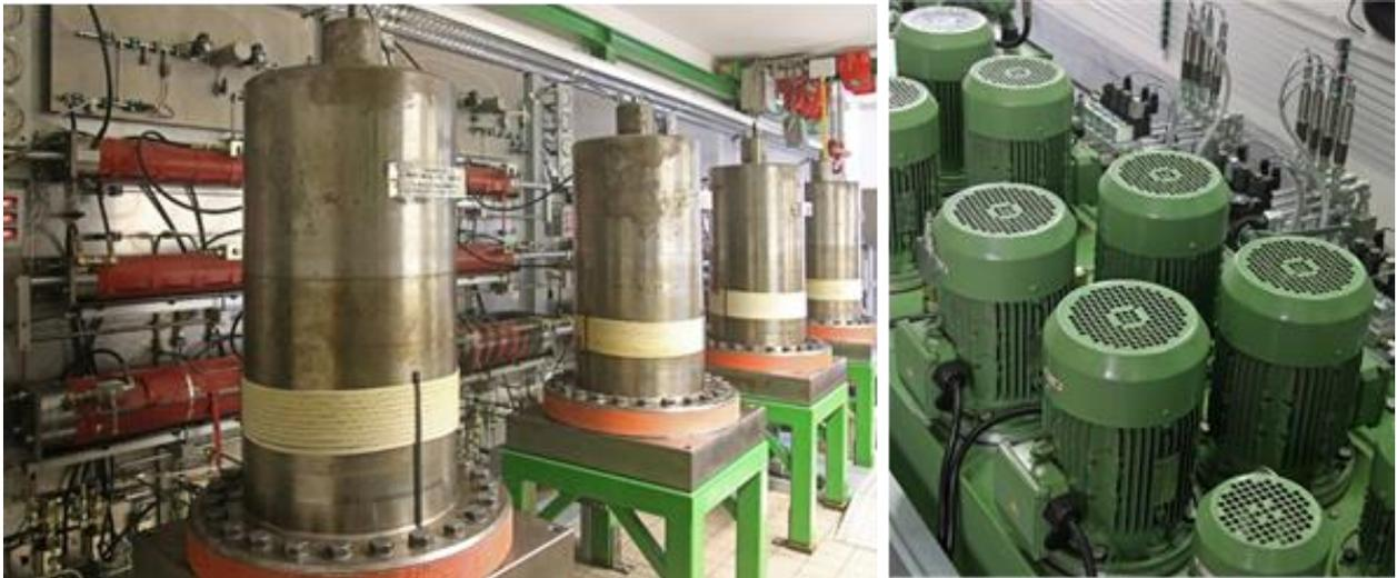
Bild 4.2: Triaxialprüfanlagen des Lehrstuhls für Geomechanik und multiphysikalische Systeme (links) und Hydraulikaggregat zur Erzeugung und Regelung der Axialdrücke (rechts)
