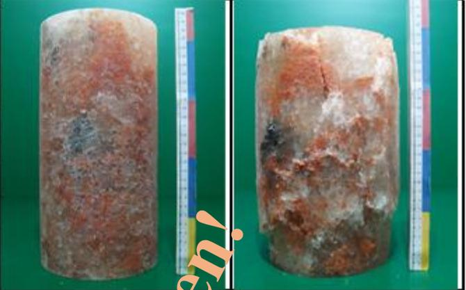
Bild 4.157: Initiale Prüfkörperdaten sowie Prüfkörperfotos vor und nach Durchführung des Verheilungsversuchs (Versuchsnummer 111)
