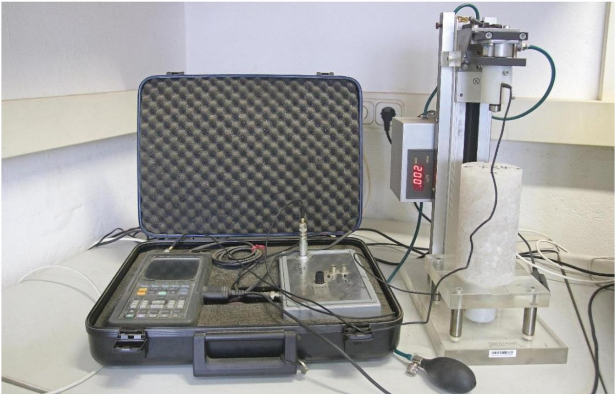
*Bild 4.1: Dehnwellenmessplatz des Lehrstuhls für Geomechanik und multiphysikalische Systeme*
