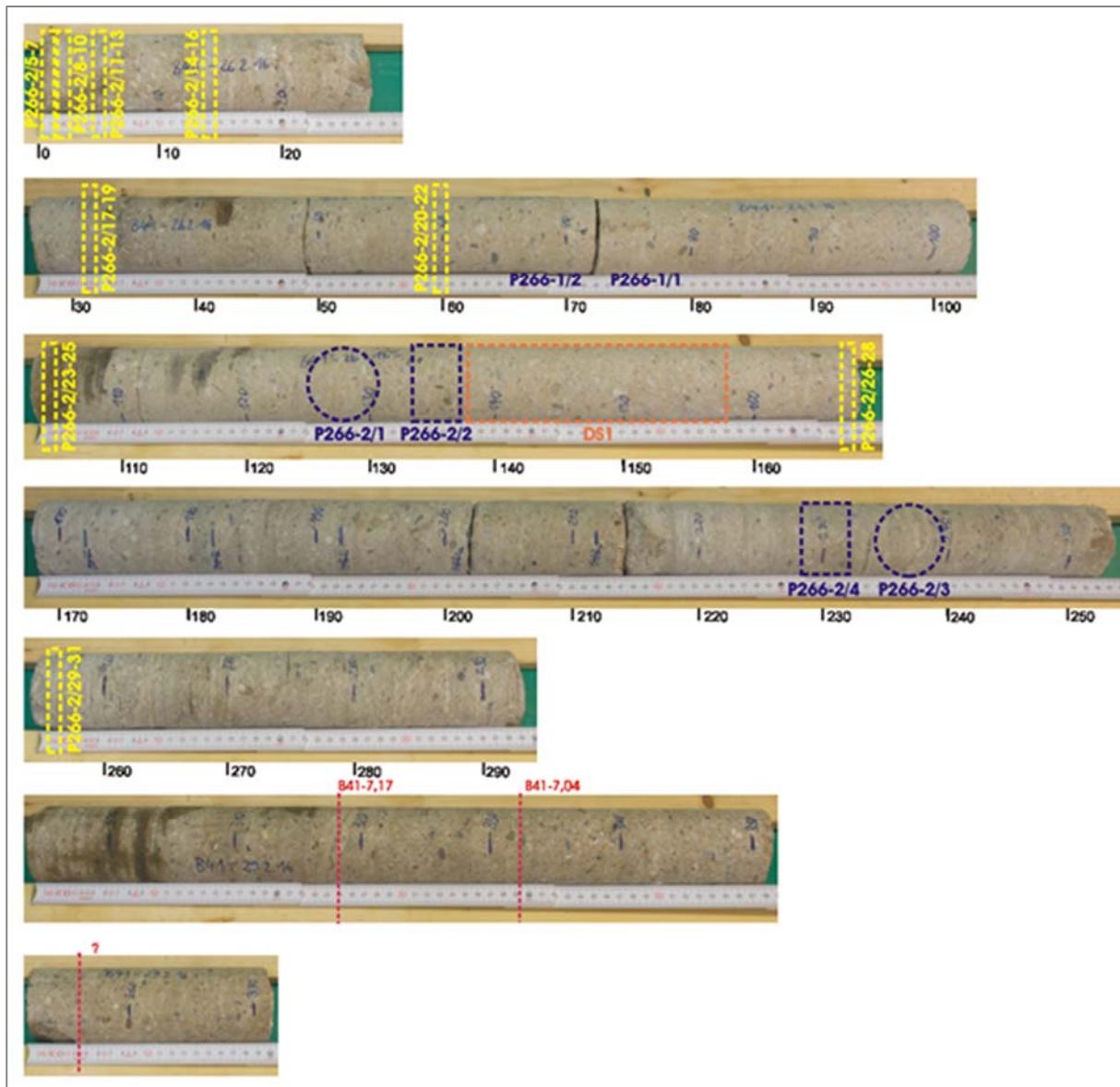
Abbildung 14: Kernfotos der Bohrung B41 mit Probenahmebereichen
