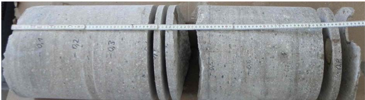
Abbildung 56: Bohrkern der Überbohrung der B34
