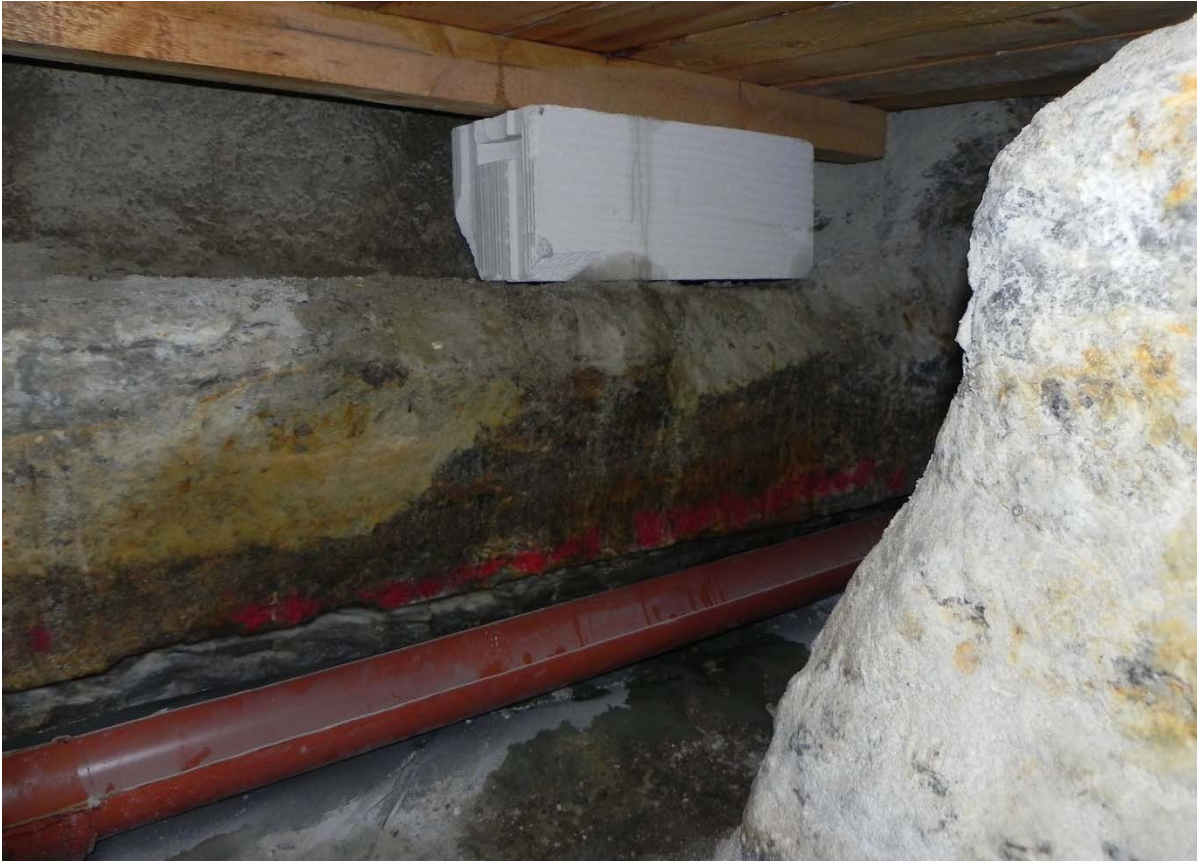
Abbildung A-18: Austreten von Lösung (aus Bohrlochversuchen) in der Auffangrinne (aufgenommen am 04.01.2017)
