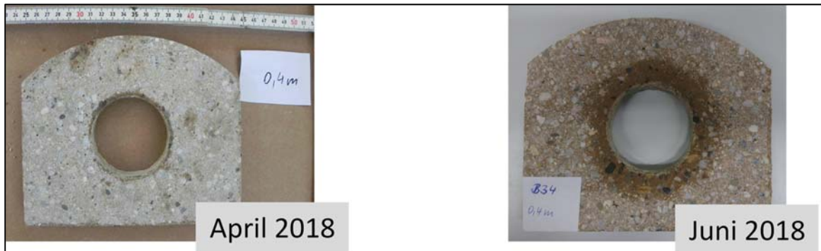
Abbildung 57: Optische Veränderung am Beispiel der Bohrkernscheibe bei 0,4 m; links: unmittelbar nach der Herstellung (Schnitt aus Bohrkern, Abbildung 56); rechts: „vermeintliche Lösungsfront“, welche sich erst mit der Zeit auf der frisch geschnittenen Oberfläche der Scheibe gebildet hat.
