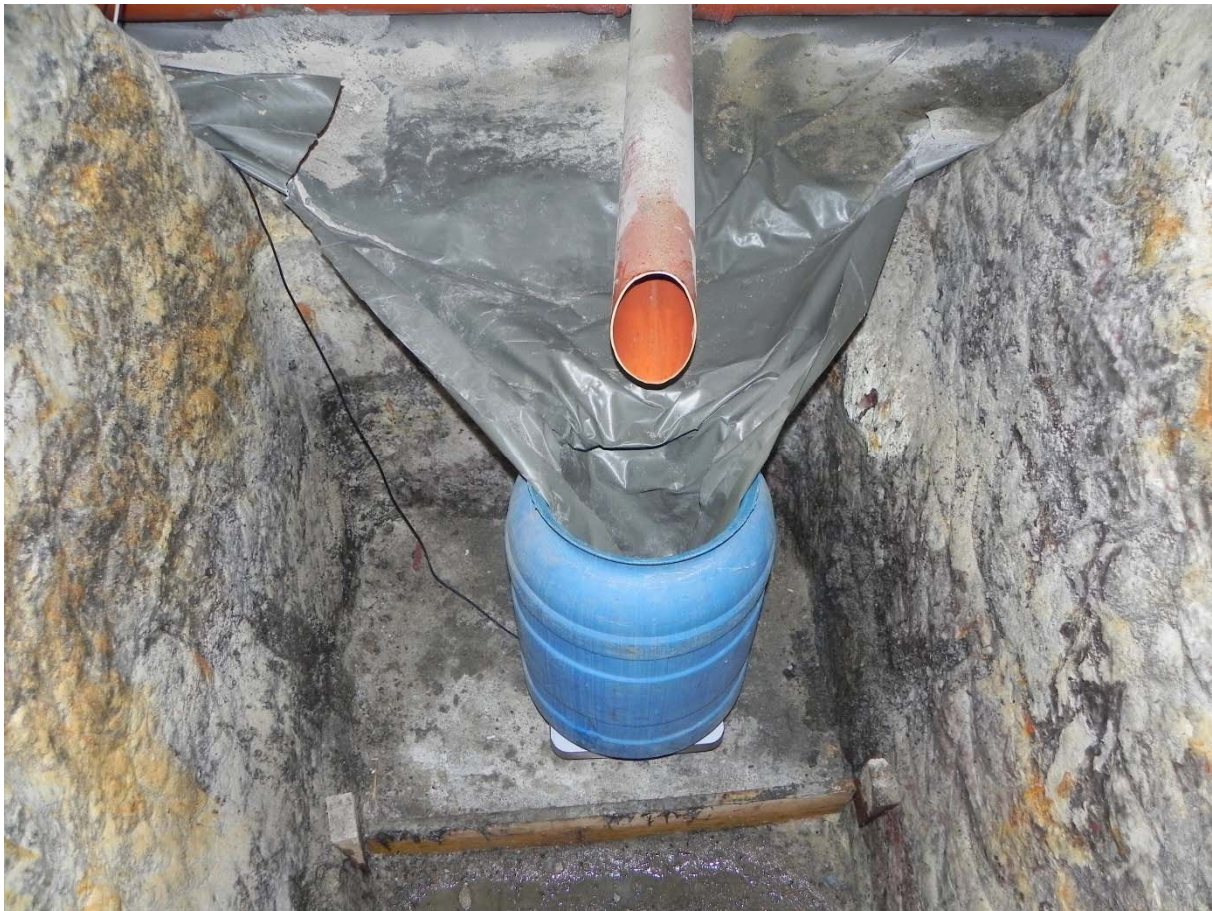
Abbildung A-10: Auffangbecken mit Fass auf einer Wage zur Quantifizierung der durchgeflossenen Lösungsmenge und Probennahme
