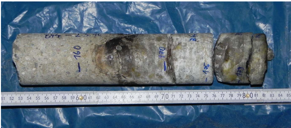
Abbildung A-7: Bohrkern der Bohrung B42: Übergang Beton – Gebirge
