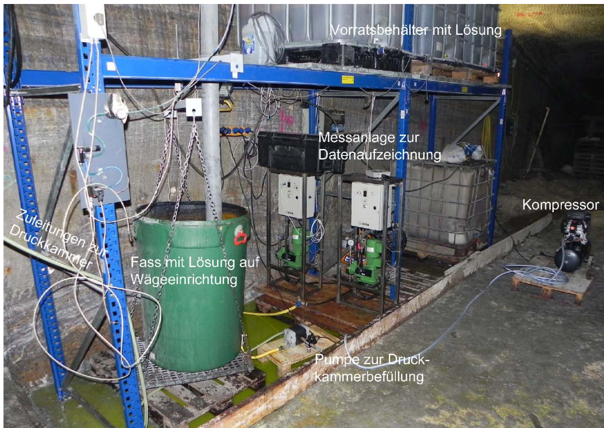
Abbildung A-14: Versuchsstand in der Begleitstrecke
