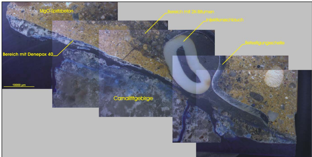
Abbildung 28: Injizierter Kontaktbereich B44 (Auflichtmikroskopie)
