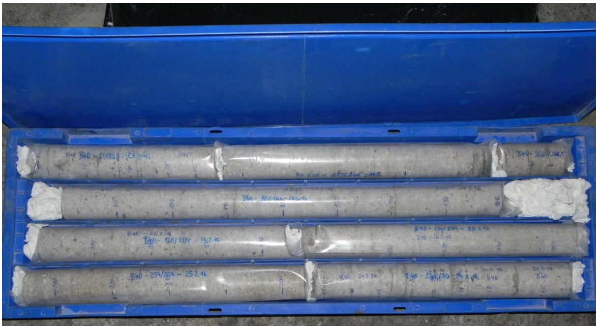
Abbildung A-5: Aufbewahren der Kerne in luftdichter Folie in Kernkisten
