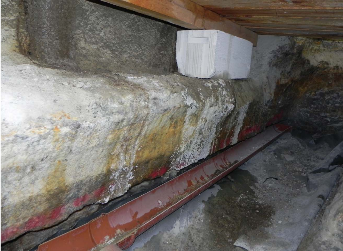
Abbildung A-20: Austreten von Lösung (aus Bohrlochversuchen) in der Auffangrinne(aufgenommen am 16.03.2017)
