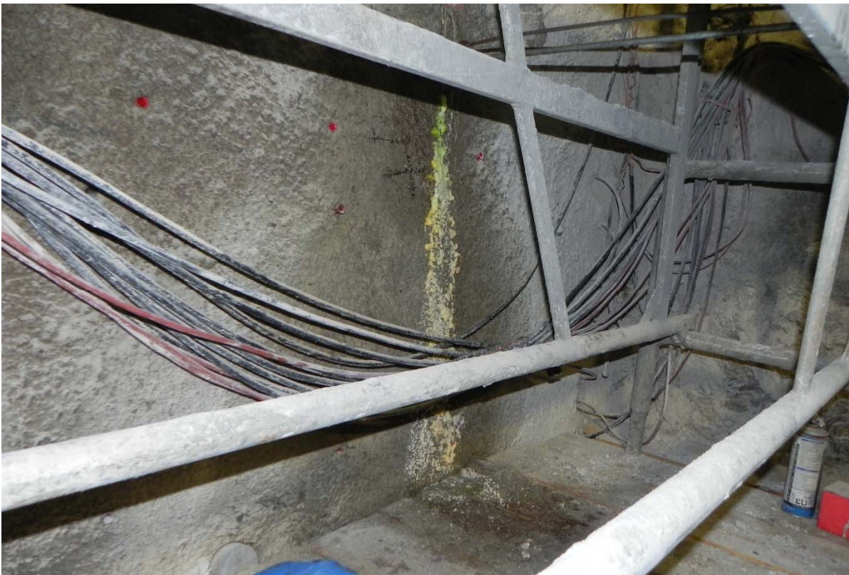
Abbildung A-19: Austritt und Kristallisation der Lösung (aus Bohrlochversuchen) an der Ortsbrust (aufgenommen am 04.01.2017)
