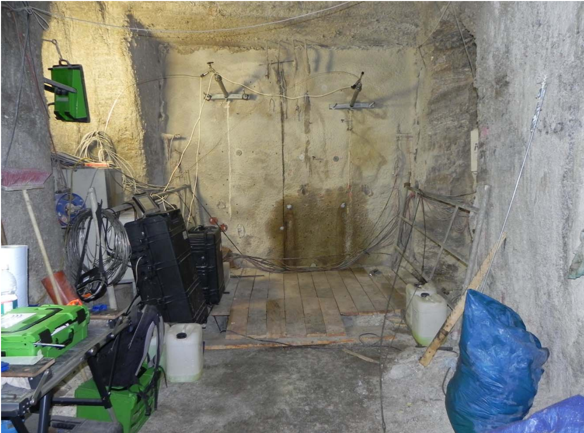
Abbildung A-21: Austritt der Lösung (aus Bohrlochversuchen) an der Ortsbrust (aufgenommen am 16.03.2017)
