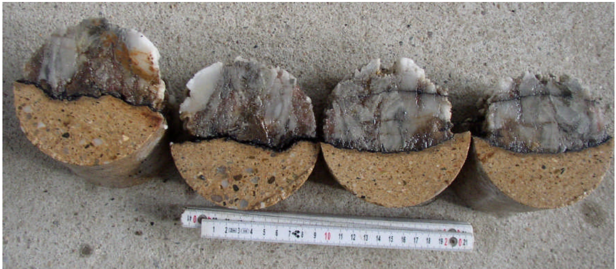
Abbildung 26: Injektion von 2K-Injektionsbitumen im konturnahen Gebirge (nachträglich erbohrte Kerne aus der KF; oben Salzgestein, unten MgO-Beton)
