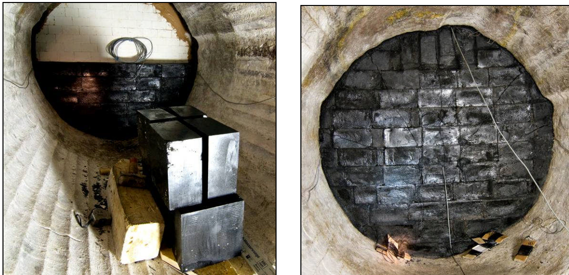
Abbildung 40: Einbau der Asphaltsteine in den vorbereiteten Versuchshohlraum (links) und fertig gestellte Asphaltmauerung vor dem Einbau des Druckkissens (rechts).
