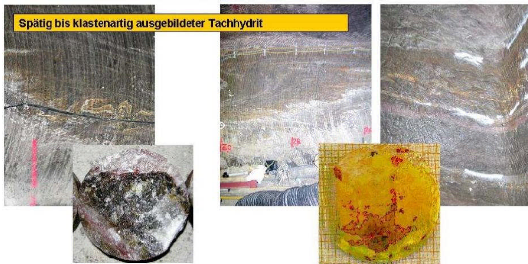
Abbildung 6: Spätig bis klastenartig ausgebildeter Tachyhydrit in den Bereichen der Schicht 7a (rechtes Bild) und in der Schicht 6 Varietät A (Bild Mitte und links), die Kernaufnahmen zeigen einen Grenzbereich zu einer aufgelösten Steinsalzbank im Bereich der Schicht 8 (links) und spätig ausgebildeten Tachyhydrit aus dem hangenden Lagerteil (rechts)
