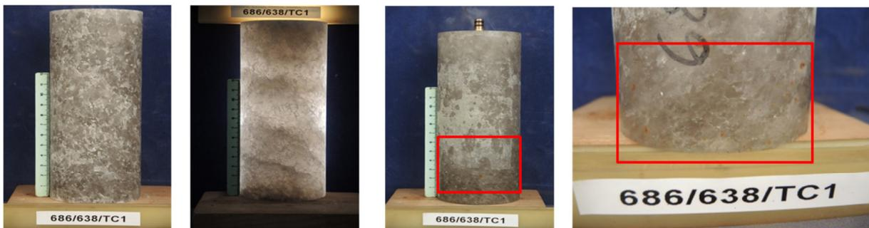
Abbildung 5-12 Fotodokumentation des Steinsalz-Prüfkörpers aus Versuch #3. Links: Prüfkörper VOR dem Versuch (im Auf- und Durchlicht) bzw. Rechts daneben: nach dem Versuch und Injektion des Farbtacers (mit punktuellen Durchtrittspunkten)
