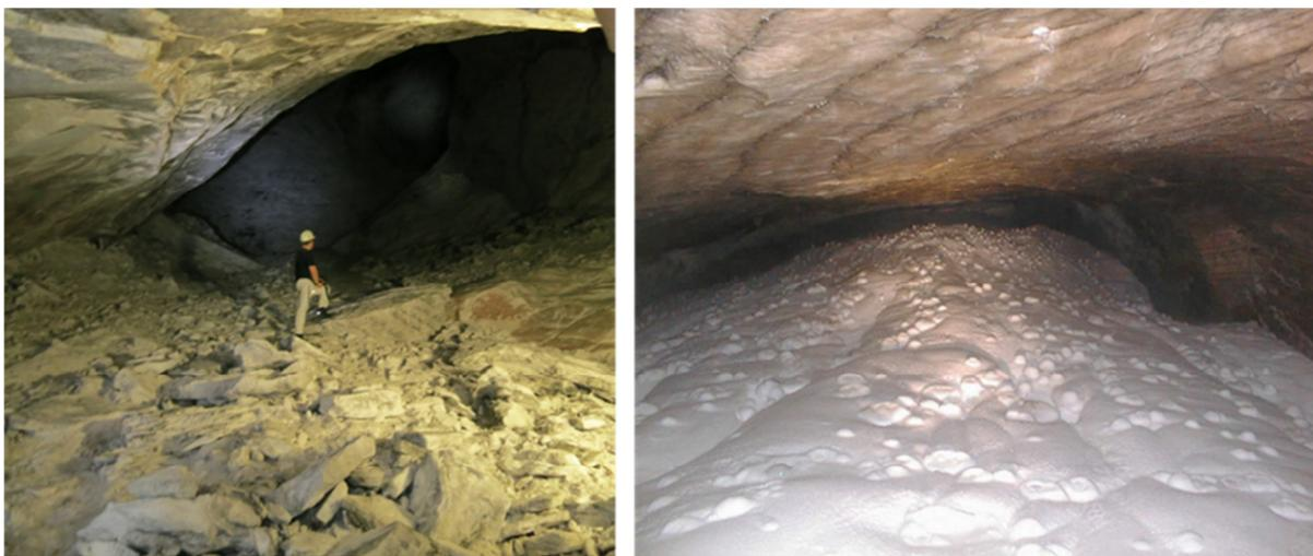
Abbildung 3-5 Links: Durch eine Sprengung am 1.10.2013 geöffnete natürlich entstandene CO<sub>2</sub> Kaverne mit einem Volumen von ca. 100.000 m<sup>3</sup> in der Grube Unterbreizbach Rechts: CO<sub>2</sub>-Gletscher nach einem Bohrloch blow-out
