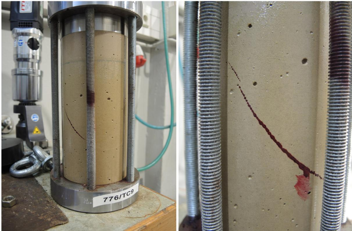
Abbildung 5-28 Fotodokumentation des Austritts des Farbtacers welcher den CO<sub>2</sub>-Durchtritt visualisiert (Zement-Versuch #4)
