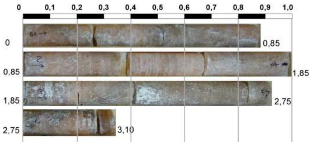
Abb. 5-3. Kernbohrung 5 (Kerngewinn 3,10 m; Auflicht).
