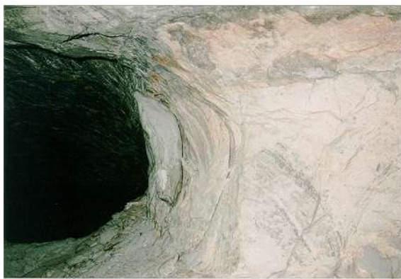
Abb. 4-2: Scherzonenbildung an Pfeilerkontur und mit dem visko-elasto-plastischen Stoffmodell berechnete Lokalisierung von dilatanten Scherzonen
