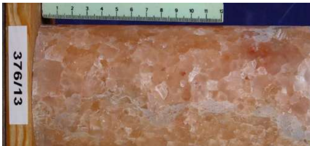
Abb. 5-4. Detailausschnitt Anhydriteinschaltung Kernbohrung 1 (Laborprobe 376/13: Kerndurchmesser ca. 10 cm; Auflicht).
