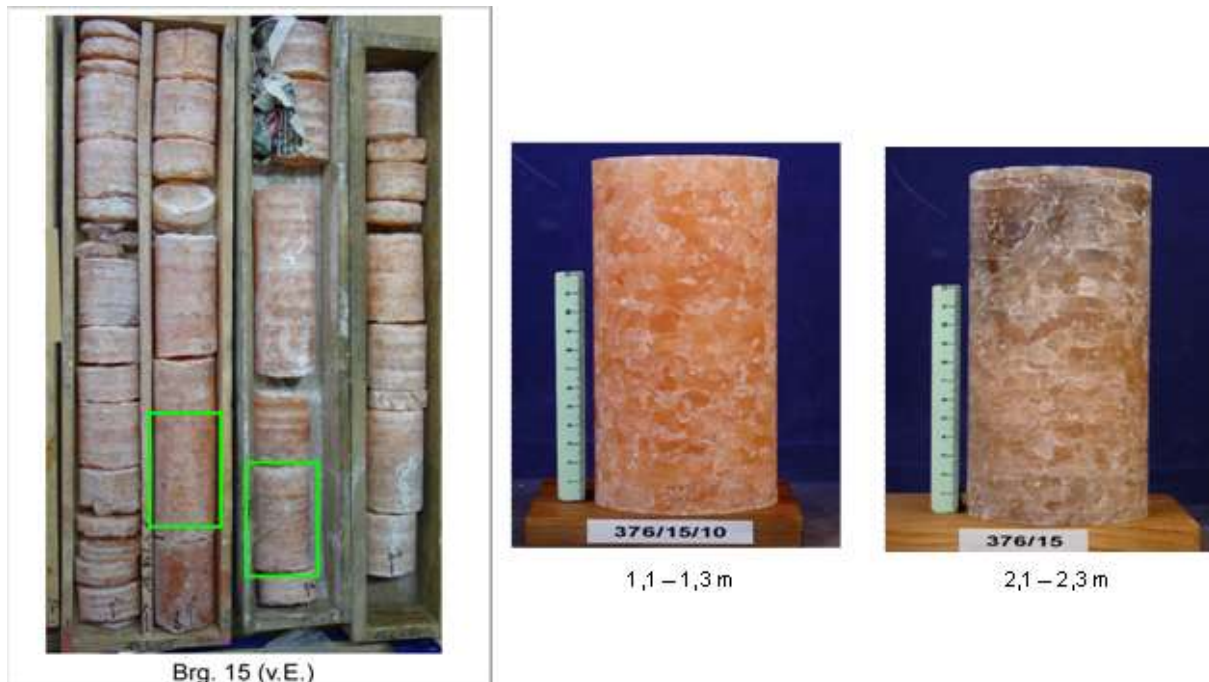
Abb. 5-20. Fotodokumentation des Kernzustandes Bohrung 15 (v. E.) sowie der für Perm-Tests hergestellten Prüfkörper.
