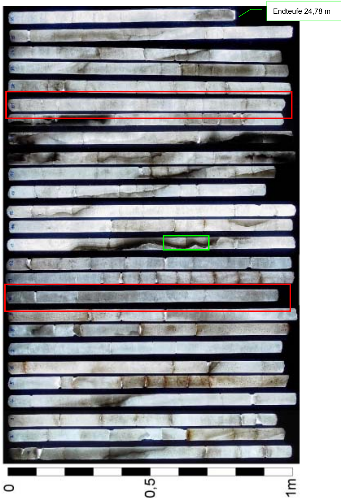
Abb. 4-6. Kernmaterial aus dem zentralen Injektionsbohrloch vom Versuchsort BfS - Querschlag 2 (nicht orientierte Kerne; Kerndurchmesser ca. 4 cm; Durchlicht). Die ursprüngliche Packerposition bei etwa 10 m Teufe sowie die endgültige Position bei 20 m Teufe sind jeweils markiert. Zusätzlich ist die Position des Gefügausschnitts aus Abb. 4-7b dargestellt.
