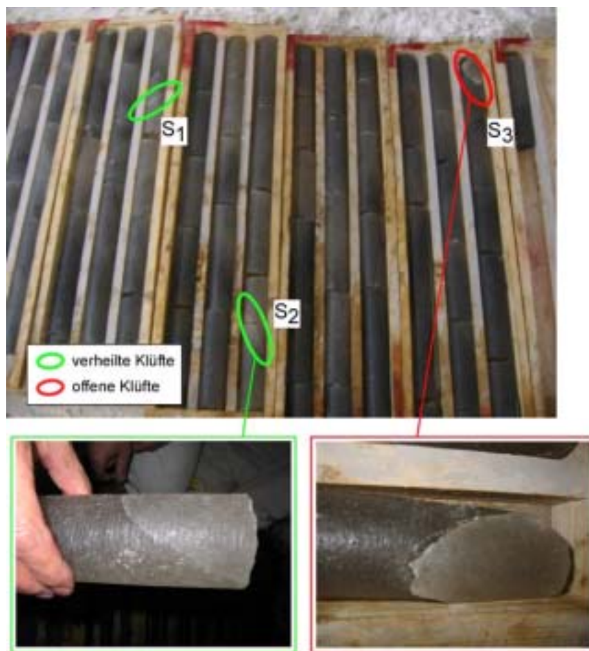
Abb. 5-3. Dokumentation des Kernmaterials aus der Forschungsbohrung HZ 156 ( \varnothing_{\text{Kerne}} = 55\text{-mm} ) - mit Lage bzw. Detailvergrößerung offener ( S_3 ) bzw. verheilten Klüfte, bergmännisch als Schnitte bezeichnet ( S_1 und S_2 ).
