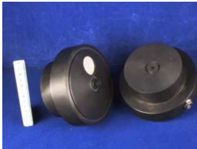
Abb. 3-23. Stempelsätze für die simultane Durchschallung und Durchströmung bzw. Fluiddruckbeaufschlagung von zylindrischen Proben.
