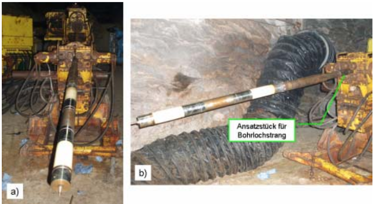
Abb. 5-14. Die 80-mm-Sonde einsatzbereit auf das Gestänge aufgeschraubt. a) Stirnansicht der Bohrmaschine. b) Seitenansicht mit Blick auf den Übergang Messsonde – Bohrgestänge.
