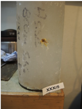
Probe nach Versuch mit punktuellm Austritt des Markers
