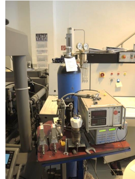
Stickstoffflasche auf der Eingangsseite / Flowmeter (Durchflussmesser) auf der Ausgangsseite
