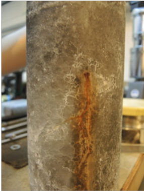
Probe nach Versuch mit punktuelltem Austritt des Markers
