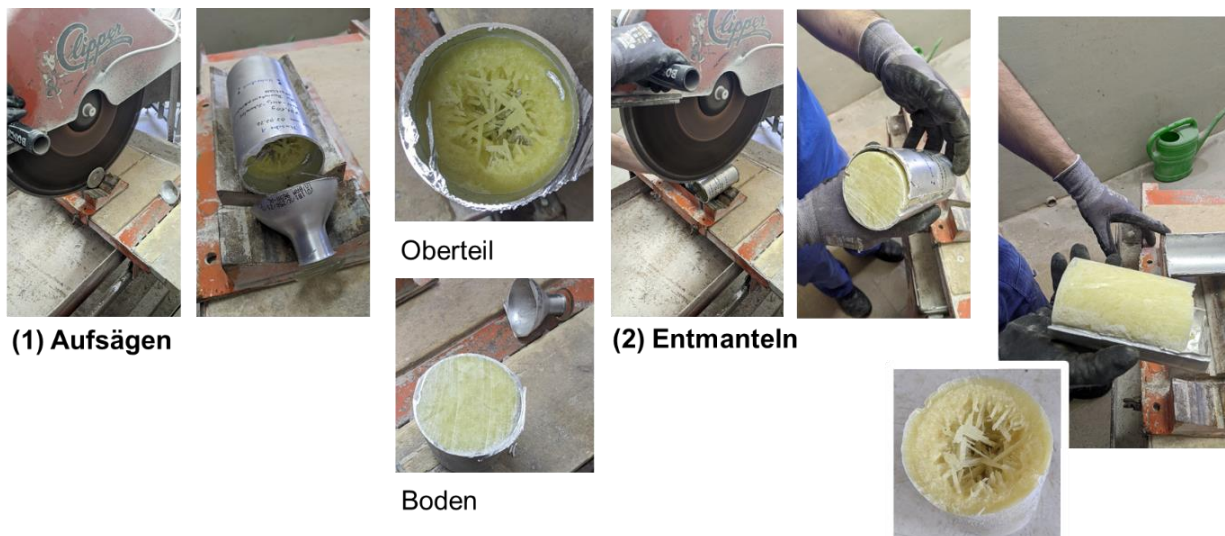
Abb. 5-7: Auschalen des Schmelzkörpers aus der Aluminiumflasche; die cm-langen Kristalleaggregate im Top-Bereich des Probekörpers sind deutlich erkennbar, während im unteren Bereich ein kompakt erstarrter Bereich vorlag.
