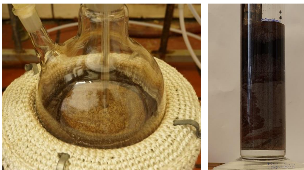
Abb. 5-52: links: Aufschmelzvorgang des KCl-CuCl-Gemischs im Zweihalskolben, rechts: erstarrte KCl-CuCl-Schmelze in Standkolben zur Dichtebestimmung.
