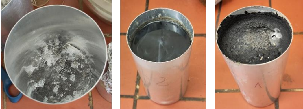
Abb. 5-12: Vorbereitung der Kompositprüfkörper für Scherversuche zum Anbindeverhalten der Schmelze an Steinsalz, links: Aluminiumbecher mit bruchrauem Steinsalzeinsatz, mittig: frisch eingegossene \text{NaCl-AlCl}_3 -Schmelze, rechts: erstarrter Schmelzkörper.
