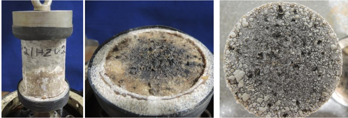
Abb. 5-39: Dokumentation eines Haftzugprüfkörpers (Schmelze auf Steinsalz), links: mit ARALDITE aufgeklebter Composite-Prüfkörper: oberer Teil Steinsalz, unterer Teil Schmelze). Die Ablösung erfolgte am Kontakt Schmelze zu Kleber; mittig: der ARALDITE-Kleber haftet noch vollständig an der unteren Zugplatte, rechts: oberflächliche Veränderungen an der Schmelzen-Endfläche.
