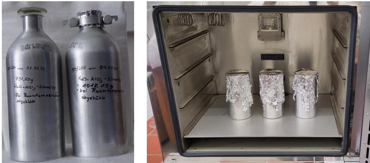
Abb. 5-5: links: Aluminiumflaschen zur Prüfkörperherstellung; rechts: befüllte Flaschen in Trockenschrank zur kontrollierten Abkühlung über 24 h auf Raumtemperatur.
