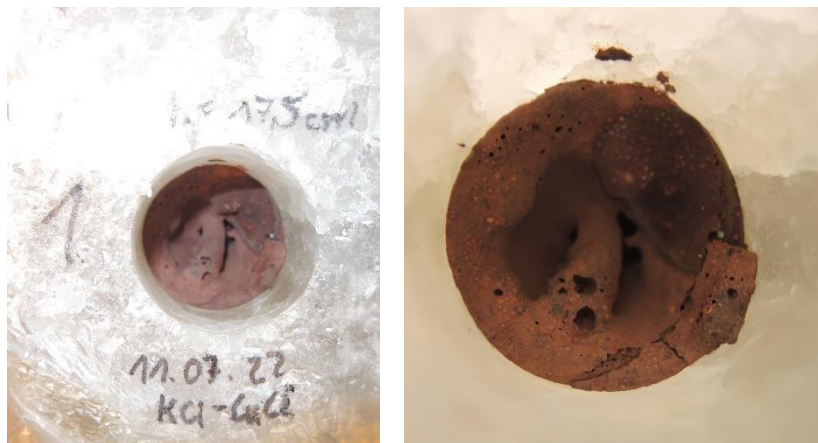
Abb. 5-56: In einem Bohrloch eines Steinsalzblockes eingegossene KCl-CuCl-Schmelze.
