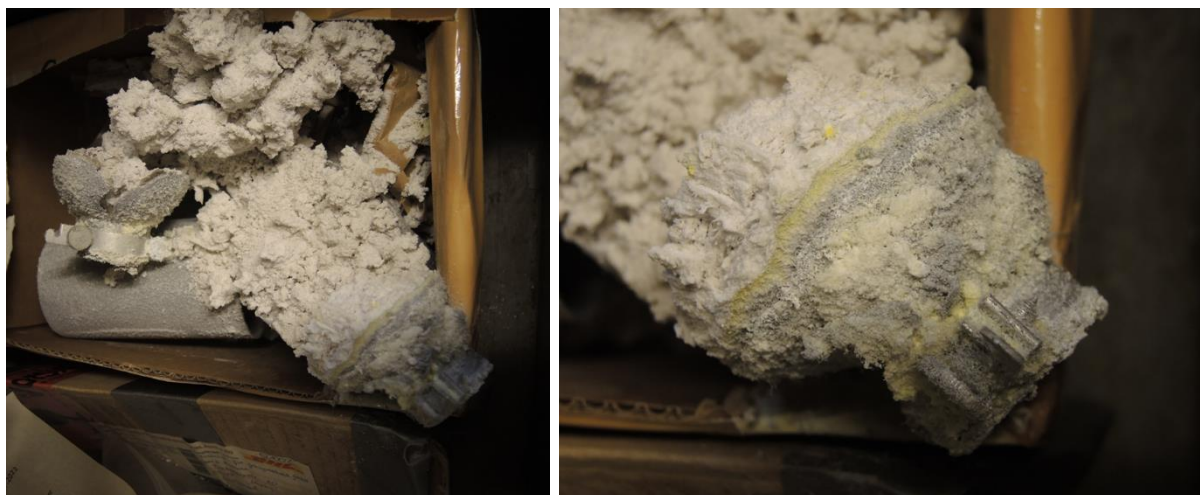
Abb. 5-18: Ursprünglich mit Schmelze befüllte Aluminiumflasche nach mehreren Wochen Lagerung an Raumluft im Labor.
