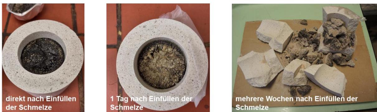
Abb. 5-49: Fotodokumentation des mit \text{NaCl-AlCl}_3 -Schmelze befüllten \text{MgO} -Baustoff A1-Bechers bis zum Sprengen des Bechers aufgrund des steigenden Kristallisationsdrucks in Folge der Kristallisation von \text{AlCl}_3 \cdot 6 \text{H}_2\text{O} und \text{NaCl} aus \text{NaAlCl}_4 .
