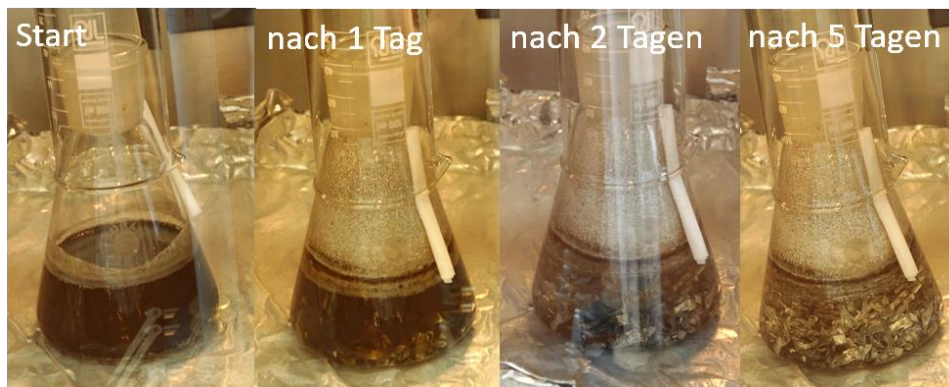
Abb. 5-4: Entfärbung der 50,5 mol% NaCl - 49,5 mol% AlCl 3 - Schmelze über Aluminiumspänen bei 200 °C und 50 mbar.
