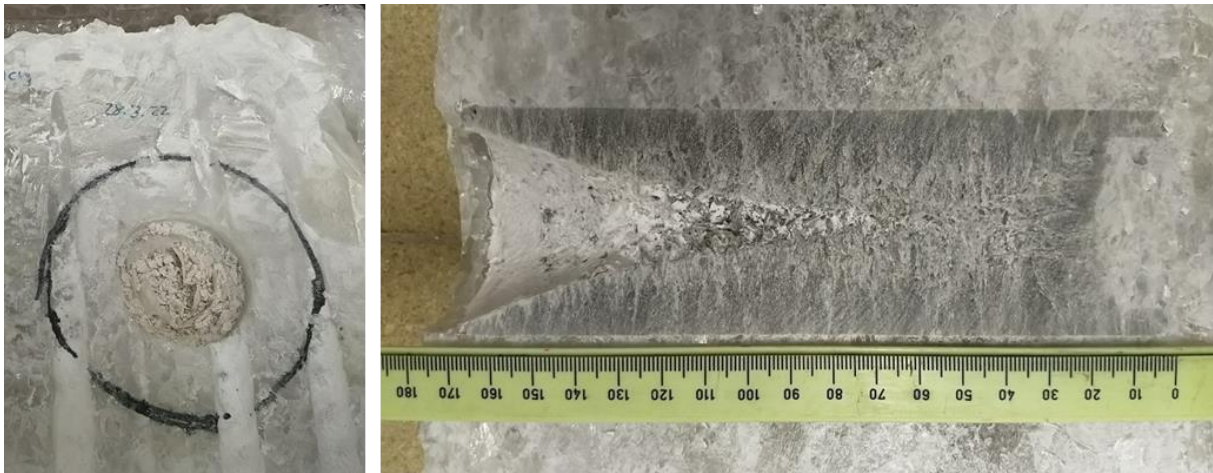
Abb. 5-38: Erstarrte Salzschnelze in Steinsalzblock-Bohrloch; links: Draufsicht, rechts: Querschnitt des befüllten Bohrlochs (vgl. Abb. 5-11).
