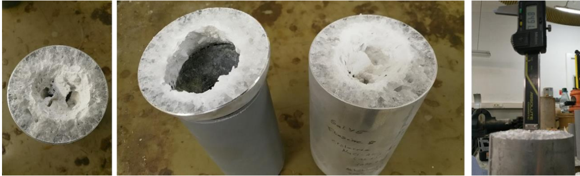
Abb. 5-10: Probekörper nach Wiederaufschmelzen und Erstarren in Aluminiumflasche: beginnend mit einem Aufschmelzen bei 160 °C (Dauer 7 Tage) und Abkühlen mit 5 K/d. Nach Entfernen der Al-Flasche zeigte sich ein signifikanter Abkühltrichter mit ca. 85 mm Tiefe (bei 130 mm Gesamtprobenhöhe).
