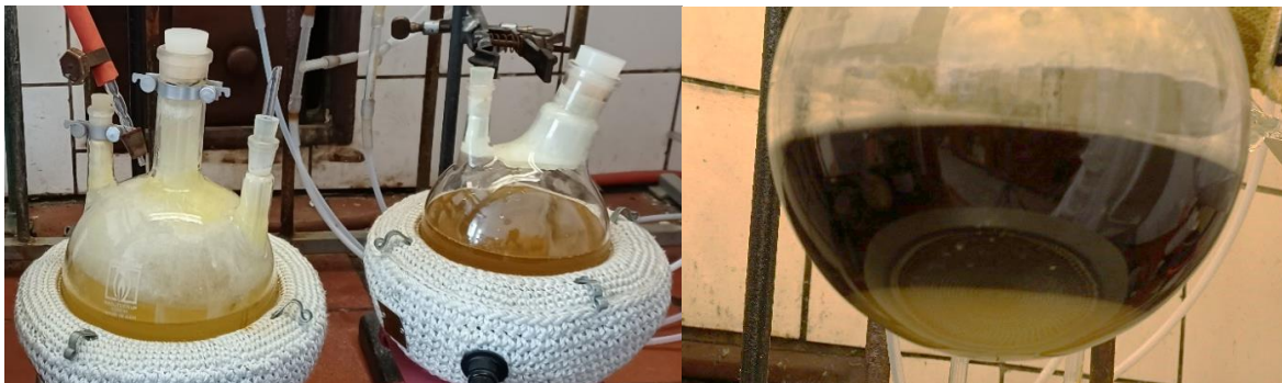
Abb. 5-1: links: gelbe \text{NaCl-AlCl}_3 -Schmelze mit resublimiertem \text{AlCl}_3 an Kolbenoberseite, rechts: dunkelbraune \text{NaCl-AlCl}_3 -Schmelze mit festem \text{NaCl} am Boden des Kolbens.
