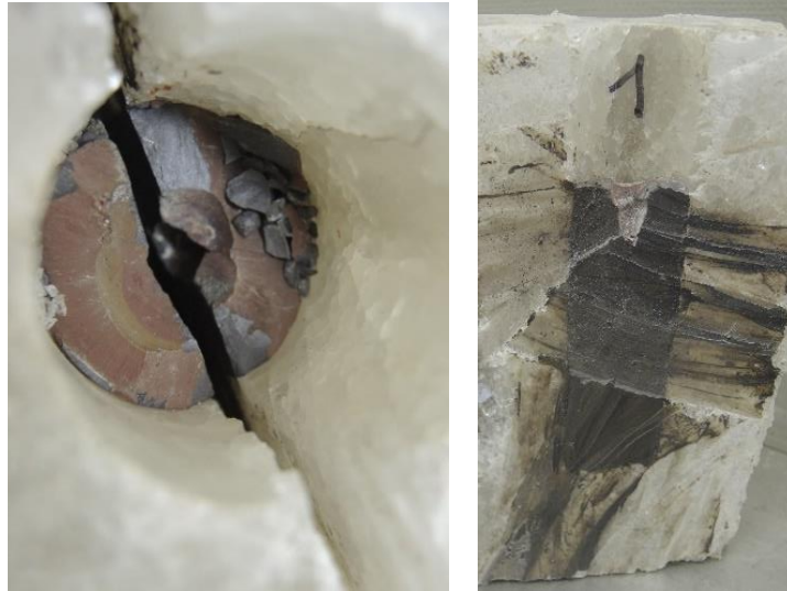
Abb. 5-57: Anschnitt der im Steinsalzblock-Bohrloch erstarrte KCl-CuCl-Schmelze (Abb. 5-56); im linken (Draufsicht) und rechten Bild ist die Ausbildung des kleinen Erstarrungskegels zu erkennen, rechts zudem die augenscheinlich gute Anbindung an das Steinsalz über den gesamten Querschnitt.
