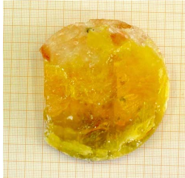
Abb. 8: Kompakte; cm-starke Lage von reinem, grobkristallinem bis spätigen Tachyhydrit (Hochbohrung Schicht B-13)
