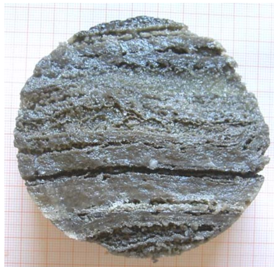
Abb. 12: Probe (UB 3) aus dem Unteren Band nach 42 Stunden, Tiefe der ausgewerteten Bereiche < 3 mm
