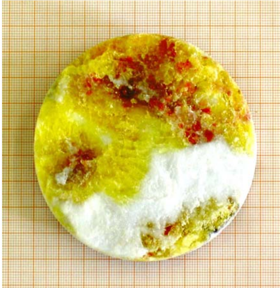
Abb. 7: Mittel- bis grobkristalline, reine Tachyhydritnester bis Dezimetergröße und weißer Kieserit (Hochbohrung Schicht B-7)
