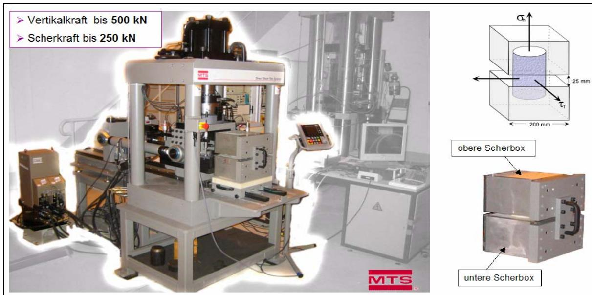
Abbildung 3.1: MTS-Scher-Test-System
